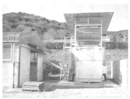
堆肥製造装置 発酵槽全体容積21m³ バケツ容積0.6m³
